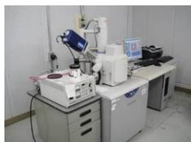
写真1 走査型電子顕微鏡 S-3400N HITACHI 製
