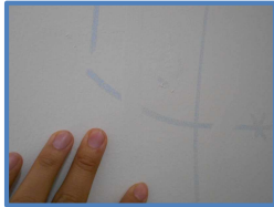
水性マーカーペンのインクがにじんで塗装後に表面にブリードしてきている(例)
