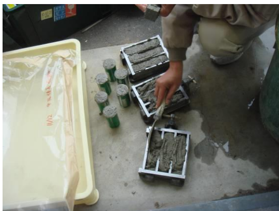
写真 3.2.12 物性測定用試験体作製の様子
