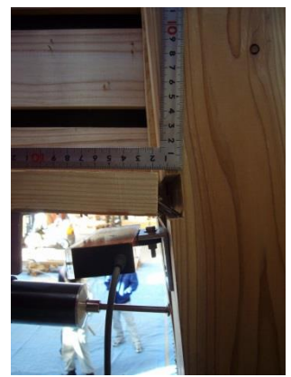
モルタル浮上り / まぐさ離れ 写真 3.2.25 No.3-1 各部破壊状況
