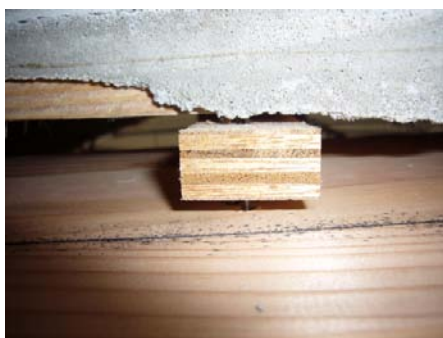
写真 3.3.34 通気胴縁の破壊状況(左:すぎ製材,右:合板)
