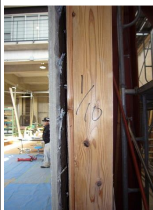
リブ端部の破損 / 防水紙破れ 写真 3.2.27 No.3-s 各部破壊状況
