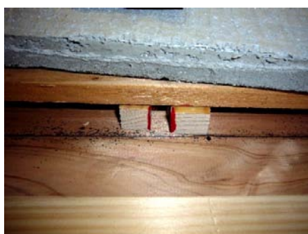
写真 3.3.34 通気胴縁の破壊状況(左:すぎ製材,右:合板)
