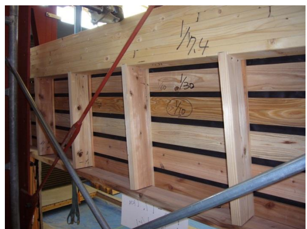
写真 3.2.33 No.3-h 垂壁の胴縁破壊
