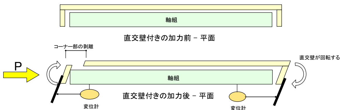
図 3.3.17 直交壁の挙動
