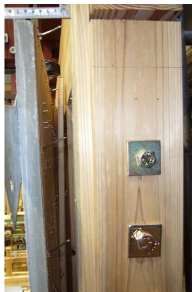
写真 3.3.41 N50 釘の引抜け (1/10rad)
