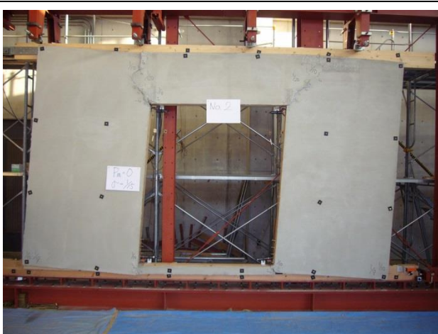
写真 3.2.22 No.2 押切時全景
