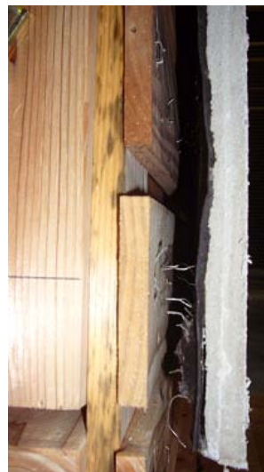
写真 3.3.39 ステープルの ・ 破断 (1/10rad)
