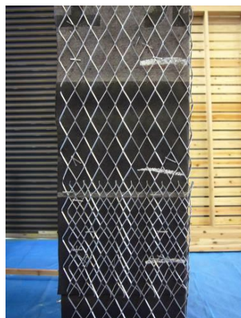
写真 3.3.10 直交壁有 (ラス縦張り)
