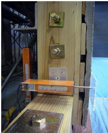
写真 3.2.17 モルタル面外変位の測定
