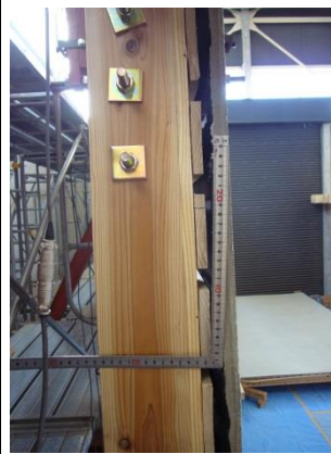
モルタル浮上り / まぐさ離れ 写真 3.2.25 No.3-1 各部破壊状況
