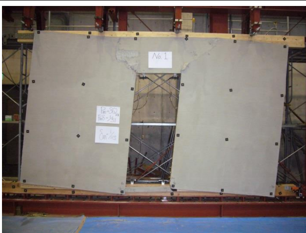
写真 3.2.20 No.1 押切時全景
