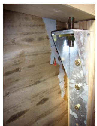
リブ端部の破損 / 防水紙破れ 写真 3.2.27 No.3-s 各部破壊状況
