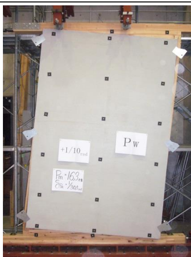
写真 3.3.31 Pw 終局状態
